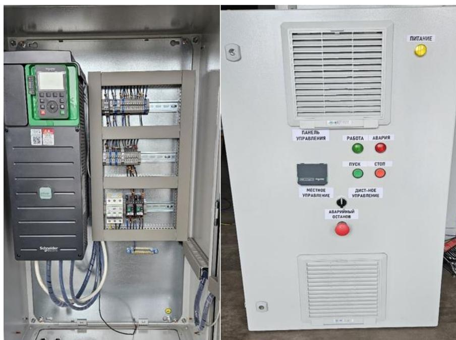
Рисунок 3.18 – Шкаф управления в собранном виде
